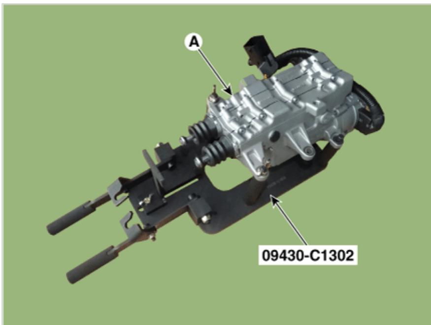
2) 拆卸离合器执行器电机(A)。
