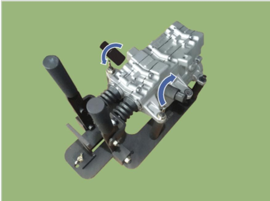
12) 拉动控制杆(A)直到听到“咔嗒”声为止，然后再次测量并核实拉杆长度(B)。
