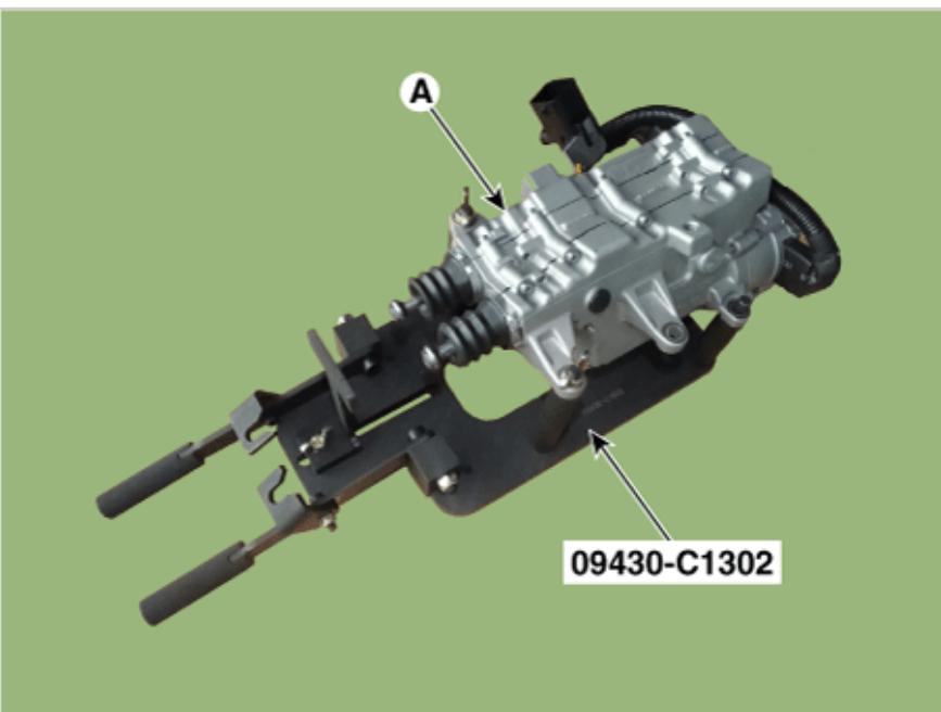
3. 拆卸离合器执行器电机(A)。
